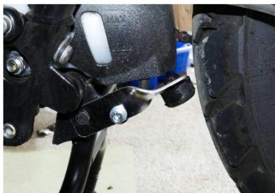
Sur les modèles T100 et Street Twin équipés de silencieux standards, appliquez un peu de savon liquide ou un spray de silicone sur le caoutchouc d'arrêt et insérer dans le trou prévu dans le silencieux gauche.
